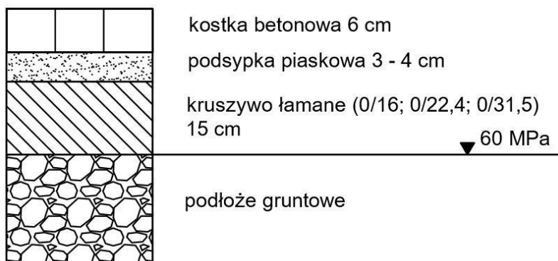
e) Nawierzchnia z kostki brukowej z podbudową z kruszywa żwirowego
