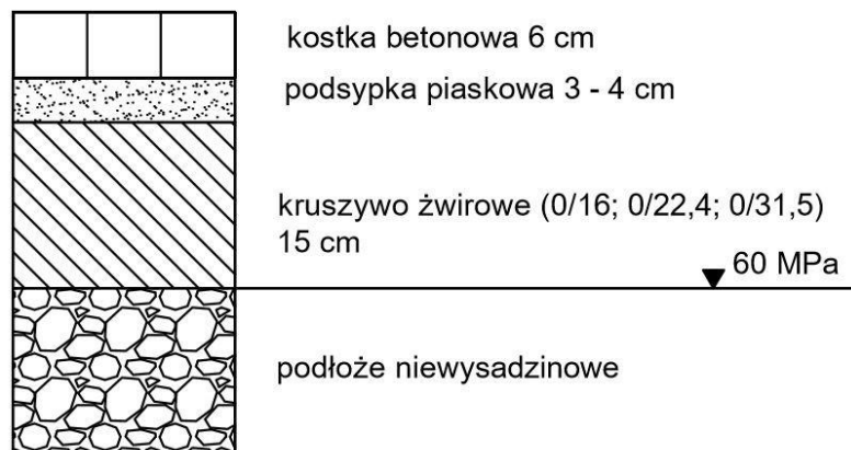
f) Nawierzchnia z kostki brukowej z podbudową z kruszywa związanego hydraulicznie
