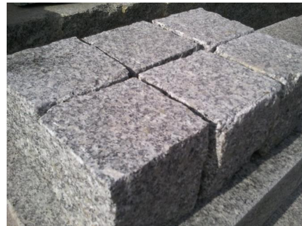
NAWIERZCHNIA Z KOSTKI GRANITOWEJ CIĘTEK JEDNOSTRONNIE, PROD. ZPG STRZEGOM PŁOMIENIOWANA; WYM. 15X15 GR. 5CM, KOLOR: SZARY
